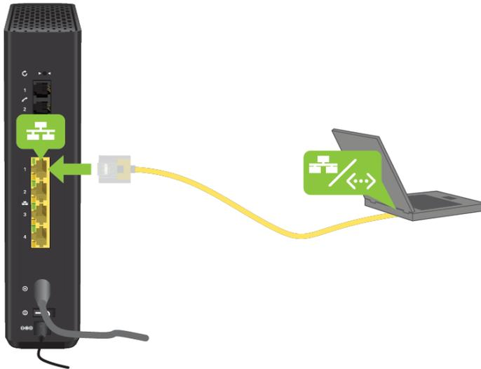
Wenn Sie ein Gerät über ein Ethernet-Netzwerkkabel anschließen möchten:
